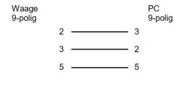
Waage 9-polig 2 — 3 3 3 — 2
