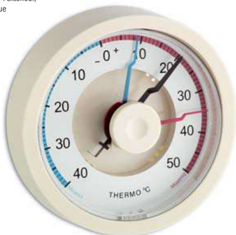
10.4001 Bimetal-Maxima-Minima-Thermometer für innen, Kunststoffgehäuse T: -40...+50 °C ☞ Ø 114 x 35 mm, 78 g, EK-EL
