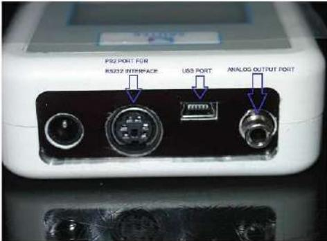
Am Gerät befindet sich ein Analogausgang. Dieser generiert ein Signal, das von +2V bis -2V geht. Dieses Signal verhält sich prozentual zu dem Max wert des Kraftmessgerätes. Z.B.: FL100 Es werden 50N in Zugrichtung gemessen, dann liegt am Analogausgang ein -1 V Signal an. 75N in Druckrichtung, dann liegen + 1,5V am Analogausgang an. Befindet sich das Gerät im PASS – Fail Modus liegen 2V bei PASS und 0V bei FAIL am Analogausgang an.
