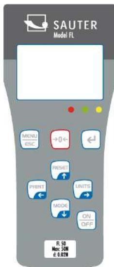
Zum Einschalten wird die Taste ON/OFF gedrückt. Nach einem kurzen Probelauf erscheint auf dem Display die gemessene Kraft in Newton. Nach diesem Probelauf stellt sich das Display automatisch wieder auf null, vorausgesetzt, dass dem Gerät keine weitere Last zugefügt worden ist.
