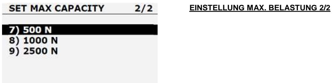
**Abb. 4.** Maske 2 für maximale Belastung
